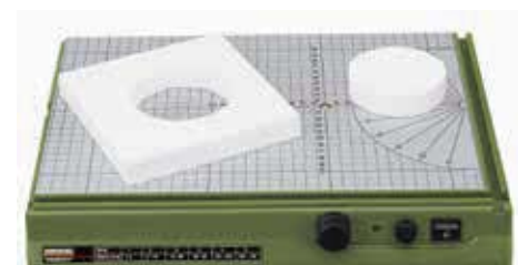
Helppo ja tehokas ratkaisu ympyränleikkaukseen: Pöytään kiinnitetään teipillä painonasta, joka toimii kiertopisteenä.
